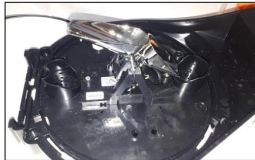
Figure 2 : Photo du dispositif à augets
